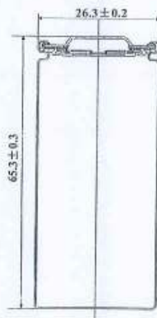
图 1 电芯外观尺寸
