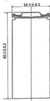
图 1 电芯外观尺寸
